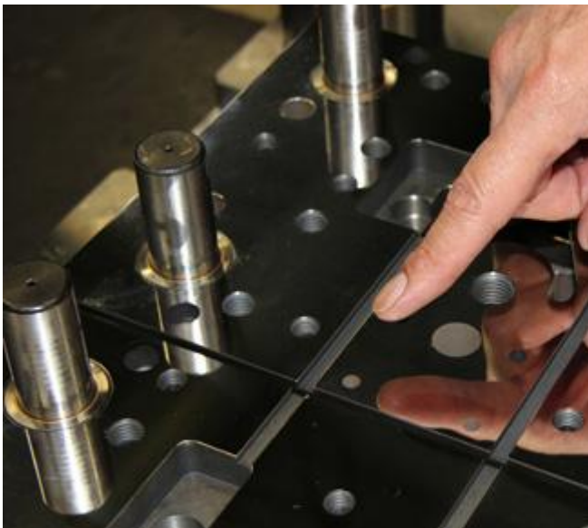
まるで鏡のように磨き上げた金型が、断面の鋭い部品をつくる (写真提供:伊藤製作所)
